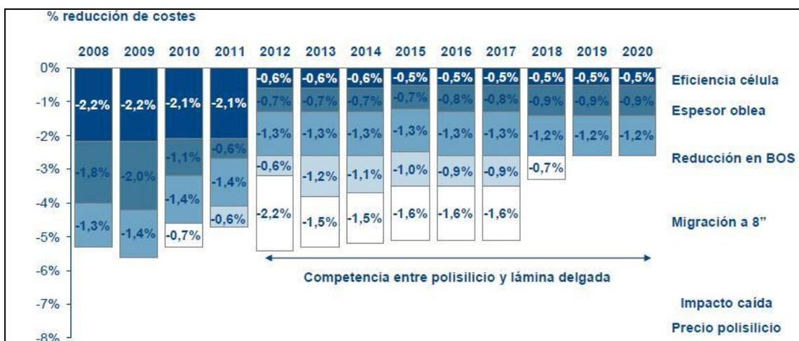
Figura 12. Previsión de reducción de costes de las instalaciones fotovoltaicas.
