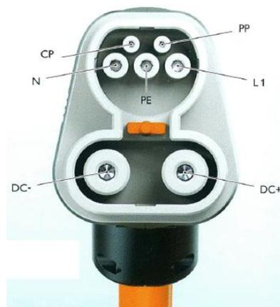
Figura 31. Conector tipo COMBO.
