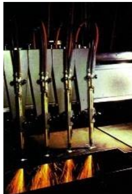
Fig. 1.- Cuatro sopletes trabajando simultáneamente sobre la misma chapa
