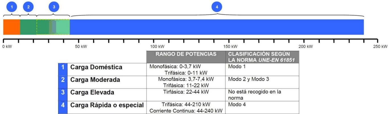
Figura 1. Tipos de carga para el VE
