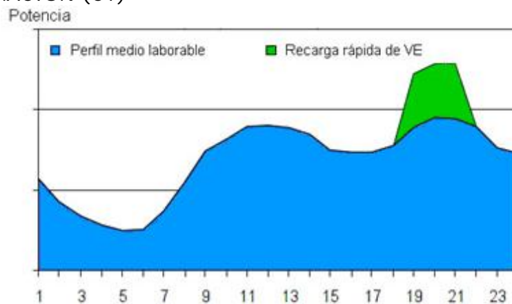
Aumento de la demanda eléctrica de un CT al concentrar la recarga del VE en los momentos de máximo consumo.
